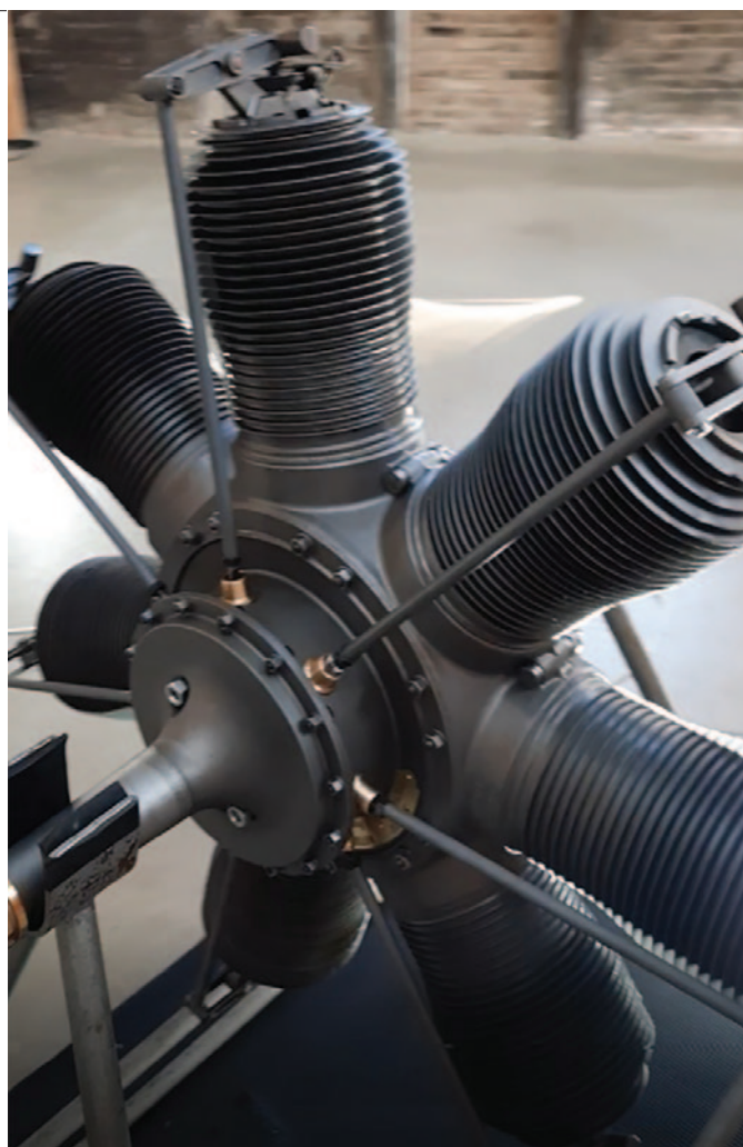
1 - Disegno con vista frontale e laterale del motore Gnome 80 HP (tratto da manuale Società Motori Gnome - Fabbrica Italiana, Officine Madonna di Campagna - Torino) e fotografia del motore reale dell'Archivio Federighi restaurato da GAVS Reggio Emilia.
