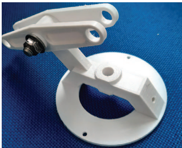
4 - Esempio di parti stampate (parte superiore dei cilindri con bilancieri).
